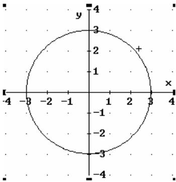
Gib in Derive in der Eingabezeile ein:  $x^2 + y^2 = 9$  und zeichne dazu den Graph. Es ist der Kreis um den Ursprung mit dem Radius 3.
