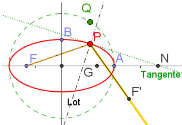
Wir wählen einen Punkt F auf der x-Achse, von dem aus ein Strahl in P reflektiert wird. G ist der bezüglich der Ellipse zu F symmetrische Punkt. I.A. verläuft der reflektierte Strahl nicht durch G.
