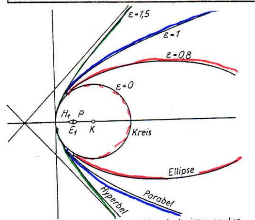
13.5-23 Abhängigkeit eines Kegelschnitts von der numerischen Exzentrizität
