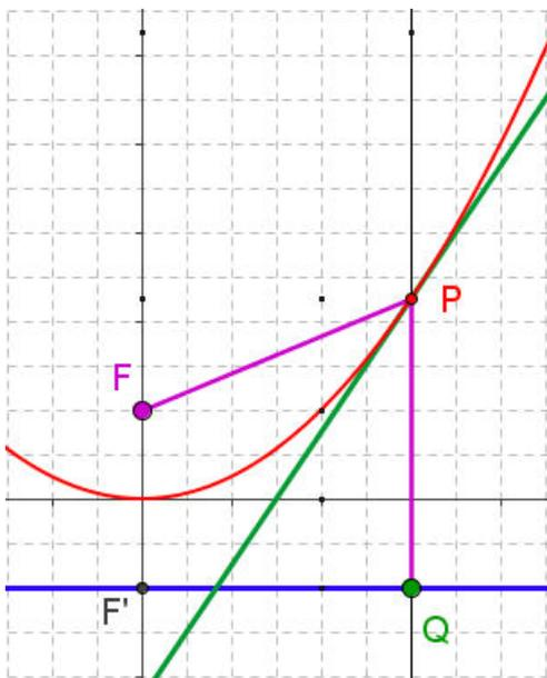
Geometrisch sind die Knicke Spiegelachsen, mit denen stets ein Punkt Q der Unterkante auf P abgebildet wird. Links ist die Realisierung in GeoGebra zu sehen.
