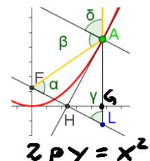
**Ergebnisse zu 12.:** Üblicherweise ist p der Abstand von F und A in der Sonderstellung, dass A dieselbe Ordinate wie F hat. Dann hat F die Ordinate p/2. Für die Parabel  $y = a x^2$ , die an der Stelle p der Wert p/2 hat, muss gelten:  $p/2 = a p^2 \Rightarrow a = 1/2p$
