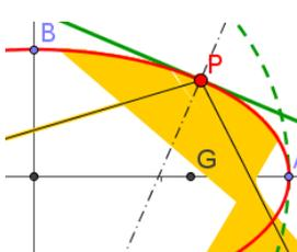
Beobachten wir nun, wie sich die reflektierten Strahlen verhalten, wenn P auf der Ellipse wandert. Letzteres erreicht man durch Ziehen an Q. Die Strahlen werden nicht gebündelt. Ziehen wir nun F so, dass der reflektierte Strahl durch G verläuft, dann tritt die Bündelung
