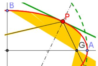
in G ein. Alle Strahlen, die von F ausgehen, werden nach G reflektiert. Darum heißen F und G die **Brennpunkte der Ellipse**.
