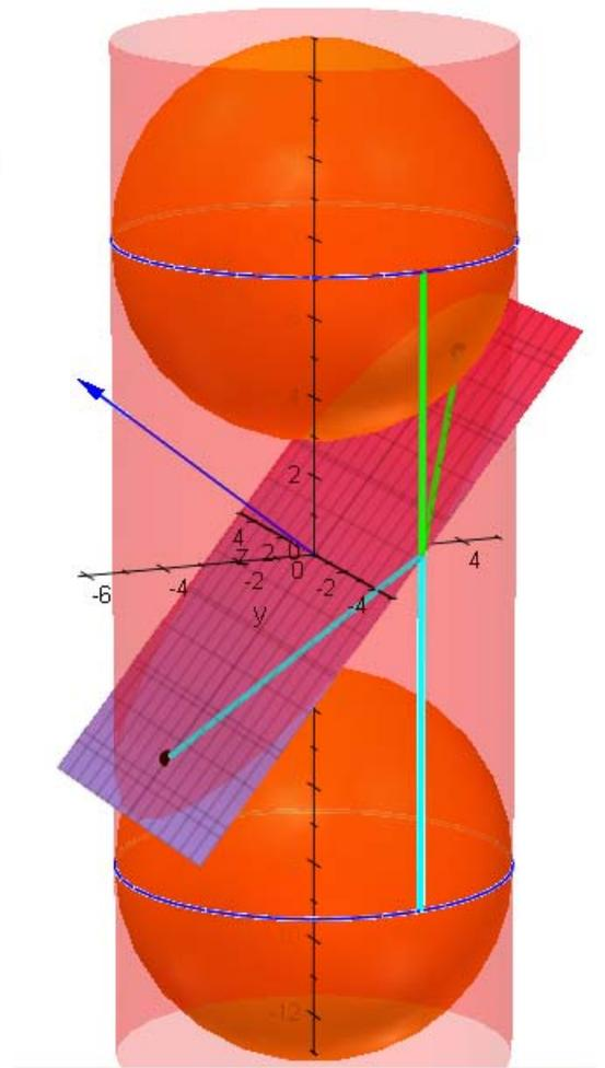
**Ellipse:** Der Abstand der Berührkeise ist konstant, er ist gleich der Gesamtfadenlänge auf der Schnittfläche, also ist der Rand der Schnittfläche eine Ellipse.
