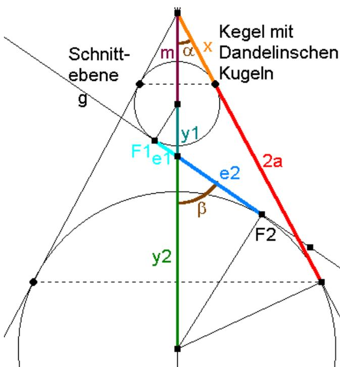
Wird der Kegel mit dem halben Öffnungswinkel  $\alpha$  von einer Ebene geschnitten, die mit der Kegelachse den Winkel  $\beta$  bildet, so entsteht als Randkurve dieses Schnittes ein "Kegelschnitt".
