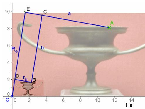
Man benötigt ein Gestänge mit zwei gleichlangen Armen  $OE = R_e = EA = a = R$ . Zwei weitere Stangen sind so angebracht, dass  $DBCE$  ein Parallelogramm ist. Dabei gilt  $OD = DB = EC = r$  und  $h = BC = DE = R - r$ .
